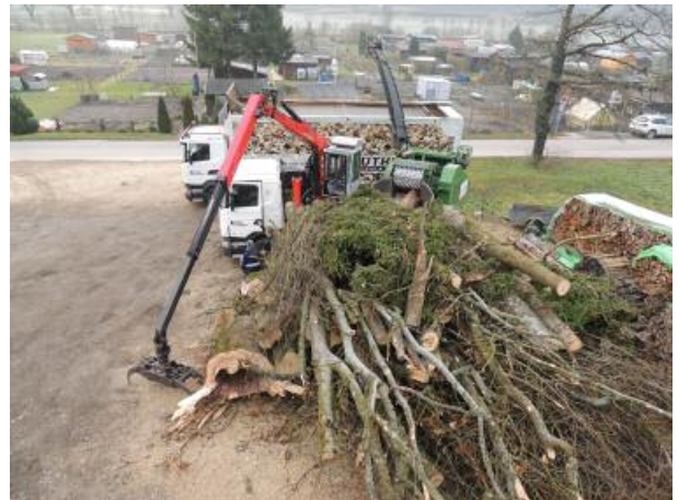
Holzhacker: aus Baumstämmen entstehen Holz-schnitzel
